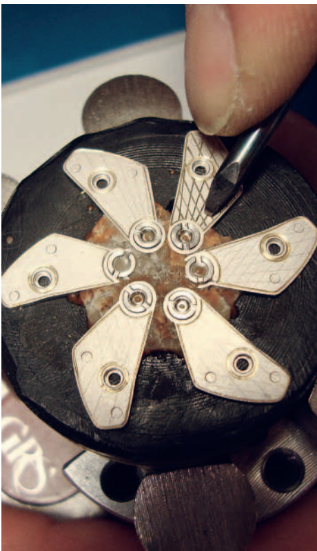
Filigrane Arbeiten: Bei Alexander Shorokhoff versteht man sich auf feine Uhrwerkfinissagen. Hier werden gerade Unruhkloben von Hand graviert.
